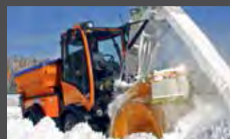
Odśnieżarka zgarniająco - odrzucająca
