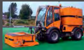
Czyszczenie powierzchni z tworzyw sztucznych
