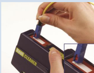
Czyszczenie wtyku SC za pomocą kasety Optipop R
