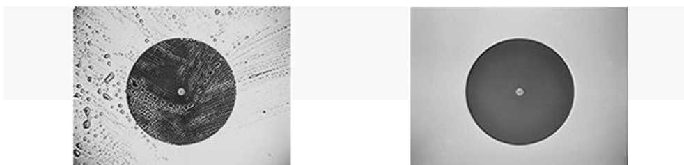
Obraz powierzchni czołowej złącza światłowodowego przed i po czyszczeniu
