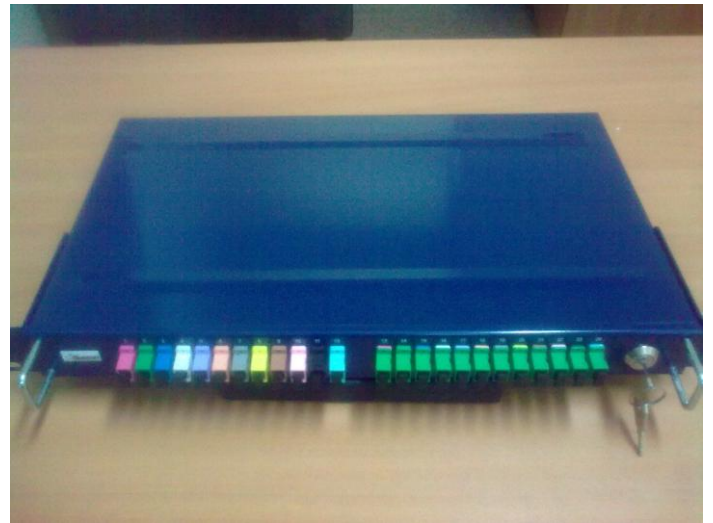
Panel światłowodowy 19"/1U 24 x SC/APC – z kolorowymi adapterami ( opcja)
