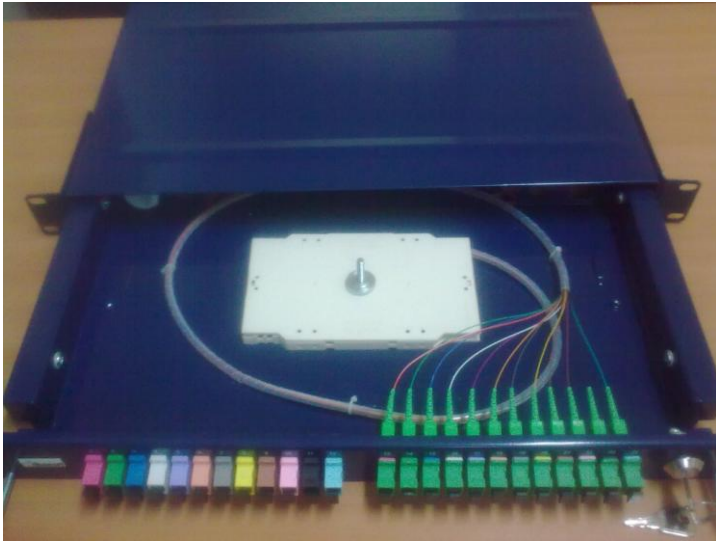
Panel światłowodowy 19"/1U 24 x SC/APC – z kolorowymi adapterami ( opcja)
