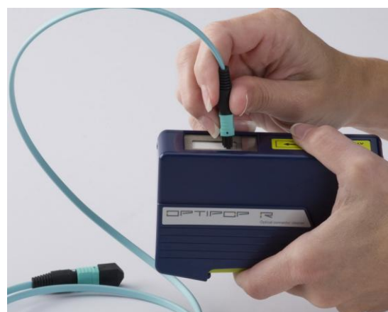
Czyszczenie wtyku MPO
