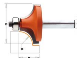
Frezy zaokrąglające HM, seria 738 mocowanie S=Ø 6 mm, seria 938 mocowanie Ø 8 mm
